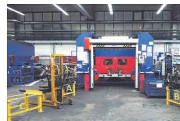
*Rüstböcke sorgen für minimale vertikale Bewegungen beim Werkzeugwechsel.*
