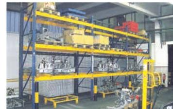
*Werkzeugregal wird nicht voll genutzt: Durch begrenzte Hubhöhe des Hydraulikwagens kann das Regal nur bis einschließlich 2. Ebene genutzt werden. Dadurch bleiben Werkzeuge auf dem Boden stehen (links im Bild).*
