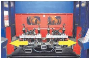
*Behinderung des Rüstvorgangs: Werkzeug muss über die Materialdepots gehoben werden.*
